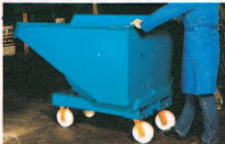
Ribalamento anteriore mediante comando a mano. Può essere movimentata tramite carrello elevatore per lo scarico a varie altezze e trasportata anche con un semplice transpallet.
