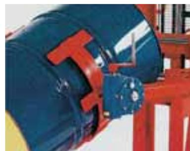
Dispositivo di ribaltamento tramite riduttore ad ingranaggi a bagno d'olio
