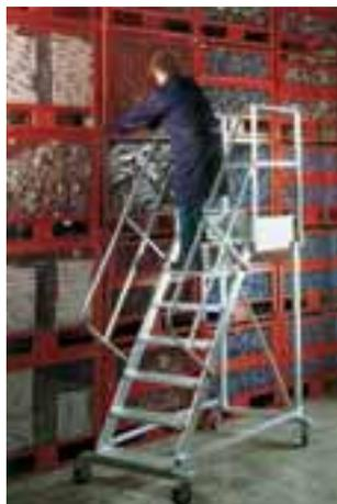
Scala a palchetto, mobile, in alluminio. Gradini in lega leggera con superficie antiscivolo con profondità mm. 200. Corrimano su entrambi i lati. N. 4 ruote pivotanti munite di freno di stazionamento diametro mm. 125. Inclinazione rampa 55°. Piattaforma superiore antiscivolo con parapetto completo sui lati laterali e fascia fermapiedi alta mm. 200. Portata kg. 200. A richiesta: personalizzazioni, come uscite frontali o laterali per accesso a sopralchi.
