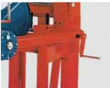
Dispositivo di presa fusti tramite vite senza fine manovrabile tramite manovella
