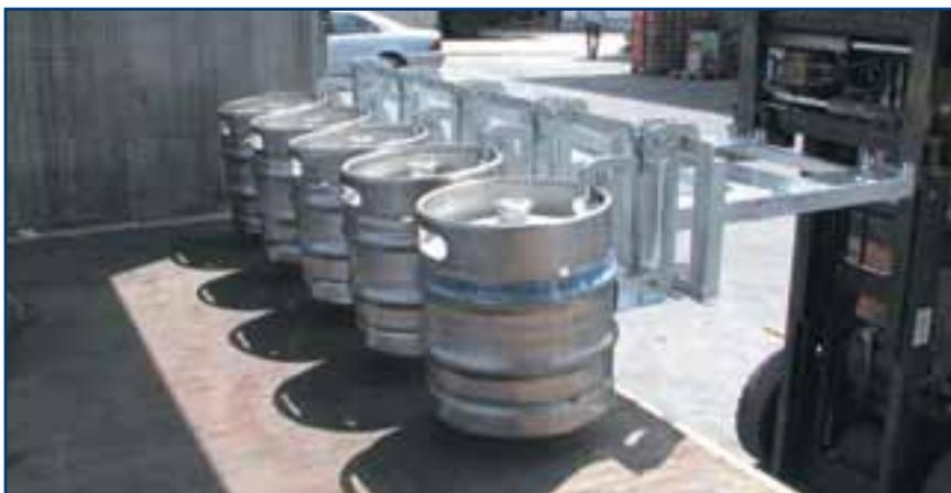
Costruzione speciale per il trasporto di fustini di birra fino ad un massimo di 5 fustini.
