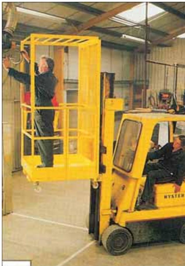
Il Vostro carrello elevatore utilizzato con La Nostra piattaforma di lavoro si trasforma in un mezzo di grande utilità e di assoluta sicurezza per sollevare una persona all'altezza consentita dall'elevatore stesso.
