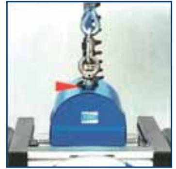
Dispositivo automatico per evitare cadute di materiale in caso di interruzione aria
