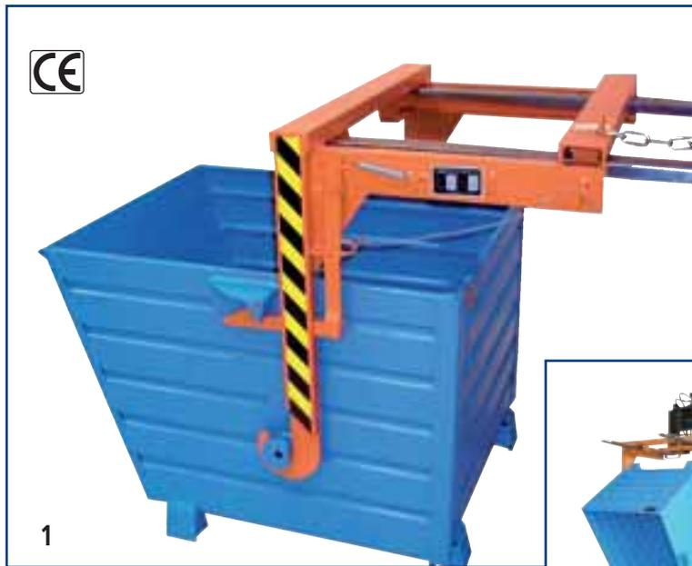
Contenitori con dispositivo di ribaltamento mod. BSK. Accatastabili fino a 3 contenitori. L'autista del muletto può prendere il contenitore senza scendere dal carrello. Volume di carico da mc. 0,3 a mc. 2.
