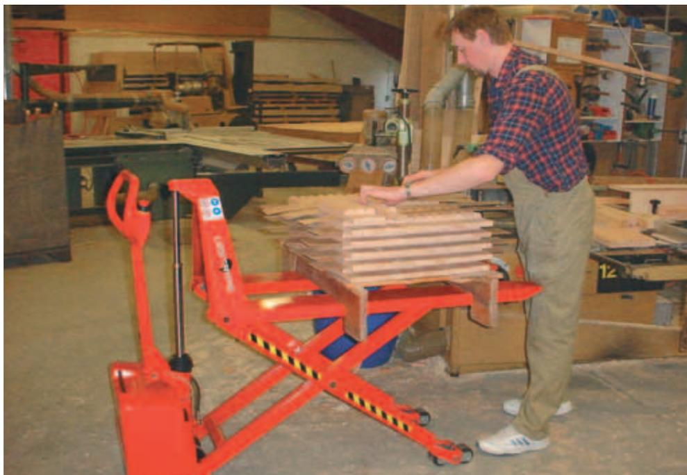
**Altezza delle forche mm 85. Pulsanti di salita e discesa situati sul timone guida. Cilindro telescopico a due stadi. Motore da 1,1 Kw. Con livello rumore massimo di 65 dB. Stabilizzatori che bloccano il carrello quando il sollevamento supera i mm 400.**
