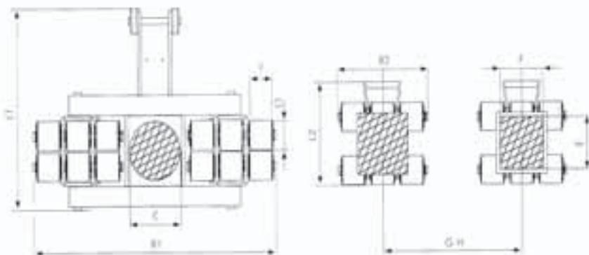
Costruzione particolarmente robusta che garantisce un funzionamento affidabile anche in condizioni gravose. La disposizione di tre rulli sullo stesso asse minimizza i carichi sui rulli stessi sul Mod. **JL 30** e **JL 40** un sistema a sospensione garantisce la massima aderenza dei rulli al pavimento anche in presenza di pavimenti sconnessi od ondulati.
